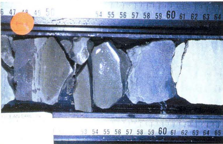
LPTM kilaşının (47-49 cm arası) hemen altındaki kalın mavimsi-grimsi kül seviyesi (57-61 cm arası), Site 1001 (aşağı Nikaragua Sirtı). Kilaşının hemen üzerindeki kıvılcaklı kül seviyesi dikkat çekicidir.
